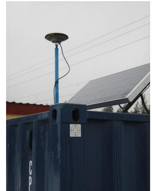
Bild 2. Basstationens position kan också följas genom att mäta ett siktmärke, vars position bestäms när basstationen sätts upp.
