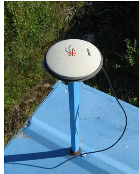
Tukiaseman tarkastusmittaus takymetrillä antennin keskeltä
