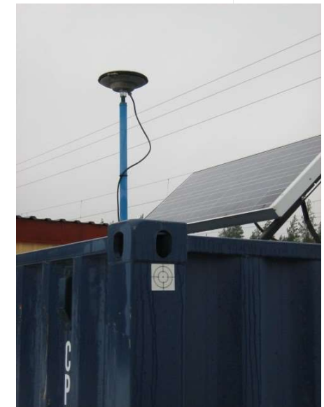
Tukiaseman sijaintia voidaan seurata myös tukiasemaan kiinnitetyistä tarratähyksestä, jonka sijainti on määritetty tukiaseman perustamisen yhteydessä.
